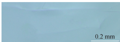
图6 消除褶皱后平整单晶石墨样品的光学显微照片
